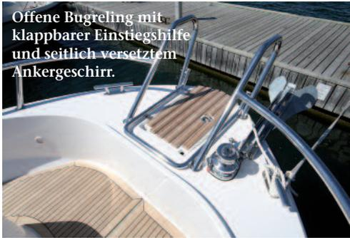
Offene Bugreling mit klappbarer Einstiegshilfe und seitlich versetztem Ankerschirr.
